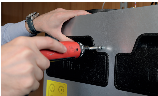
1. Fjern skruer fra frontpladen for adgang til interne dele.
