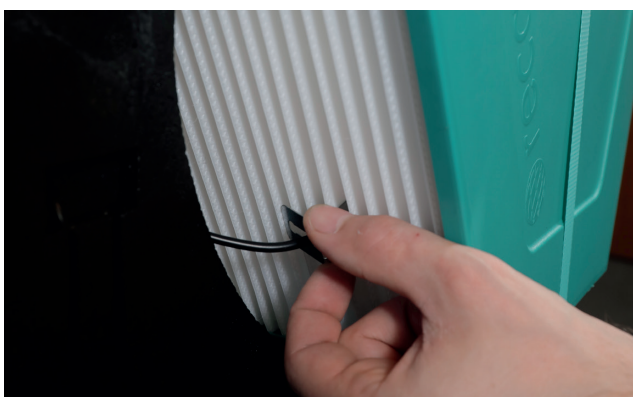
2. Démontér beslaget med føleren monteret i veksleren.
