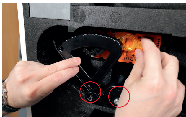
5. Démontér bypass ved at frigøre bypassklappen med den viste magnet. Fjern derefter de to skruer som vist og bypass motor kan herefter fjernes.
