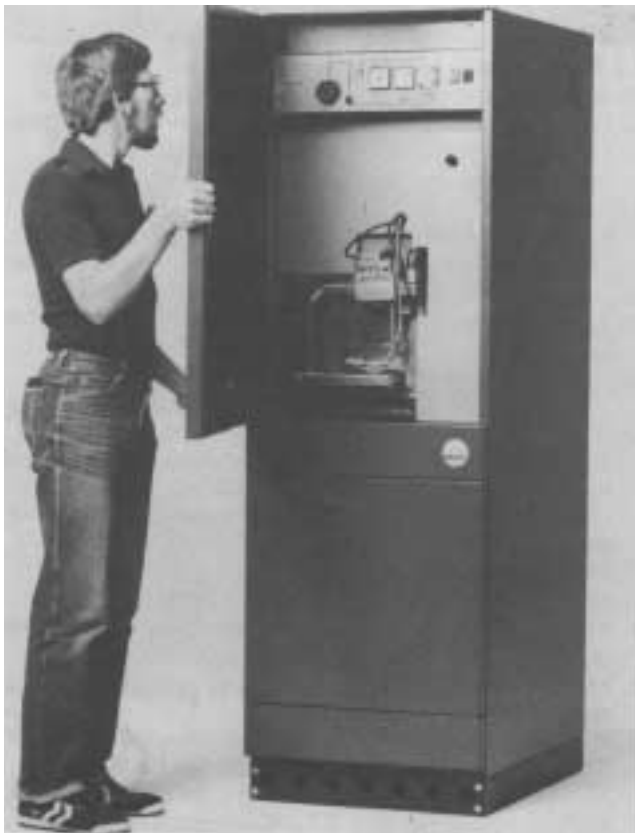
3.2.11.: Montering af frontlåger og opretning af kabinettet.
